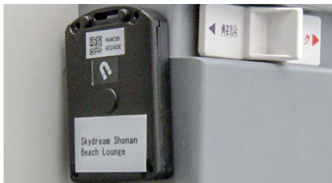
トイレの扉の施錠回数をカウントするセンサー
