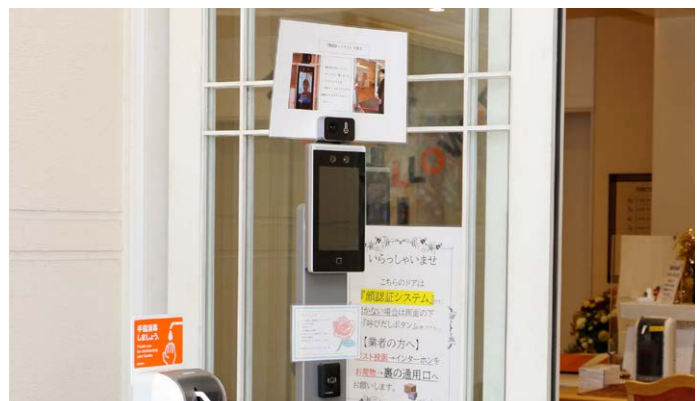
サーモカメラが撮影した画像をbotでLINE WORKSへ自動送信する仕組みにより、単独での外出が難しい入居者の離設を効果的に抑止
