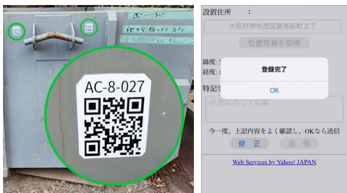
産廃コンテナに貼り付けてあるQRコードをWOFFアプリで読み込み、コンテナの位置情報をGPS取得ボタンで入力すれば、kintoneに産廃コンテナ所在地が登録される
