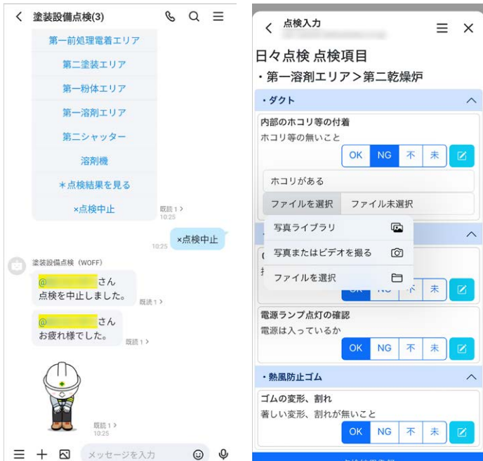
WOFFアプリでスマホに点検項目をモーダルウィンドウで表示。異常を見つけた場合、その状況を示す画像を保存して他の担当者と共有する機能も盛り込んだ
